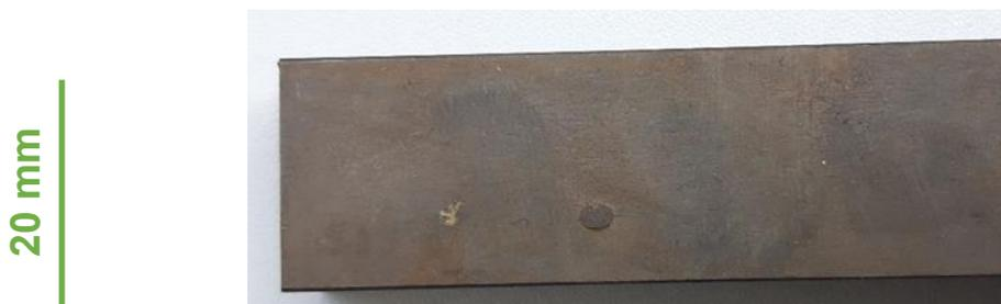
Abbildung 28: Blistering an Probe 714-1 (Grundwerkstoff)
