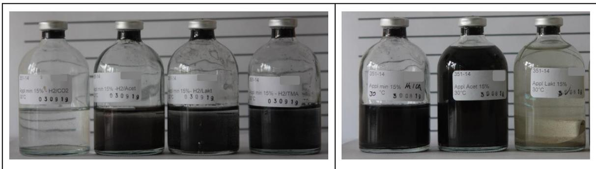
Abbildung 97: Labormikrokosmen der Kaverne H unter Wasserstoff mit Kohlendioxid, Acetat, Laktat, Trimethylamin (links v.l.n.r.) und Kaverne L unter Wasserstoff/Kohlendioxid sowie mit Acetat und Laktat (rechts v.l.n.r.)
