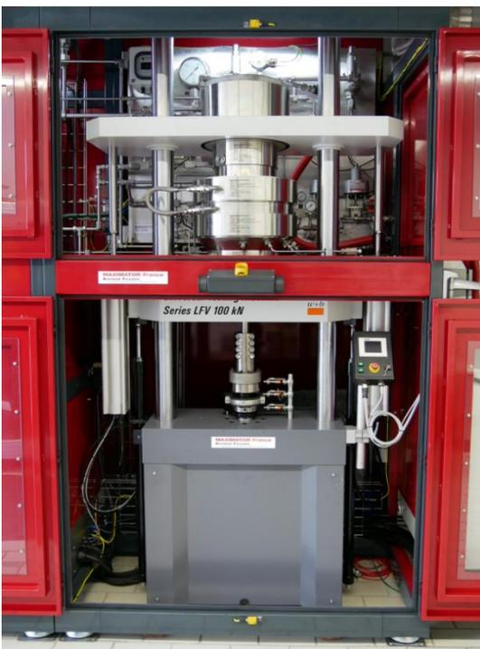
Abbildung 23: 1.000 bar Autoklav zur mechanischen Probenbelastung in Wasserstoffatmosphäre
