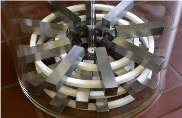
Abbildung 14: HIC-Prüfgefäß mit Proben
