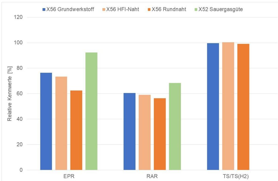
Abbildung 39: Relative Duktilitätskennwerte und Verhältnis der Zugfestigkeiten gemessen in Wasserstoff gegenüber inertem Medium (Stickstoff),  $E_pR$ : relative Bruchdehnung, RAR: relative Brucheinschnürung,  $TS/TS(H_2)$ : Verhältnis der Zugfestigkeiten
