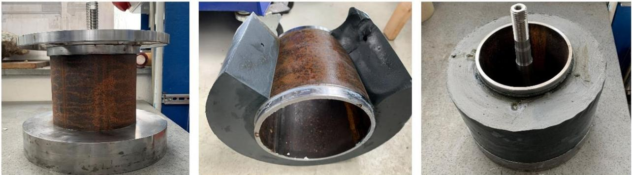
Abbildung 179: Verbundproben Futterrohr/Zementstein
