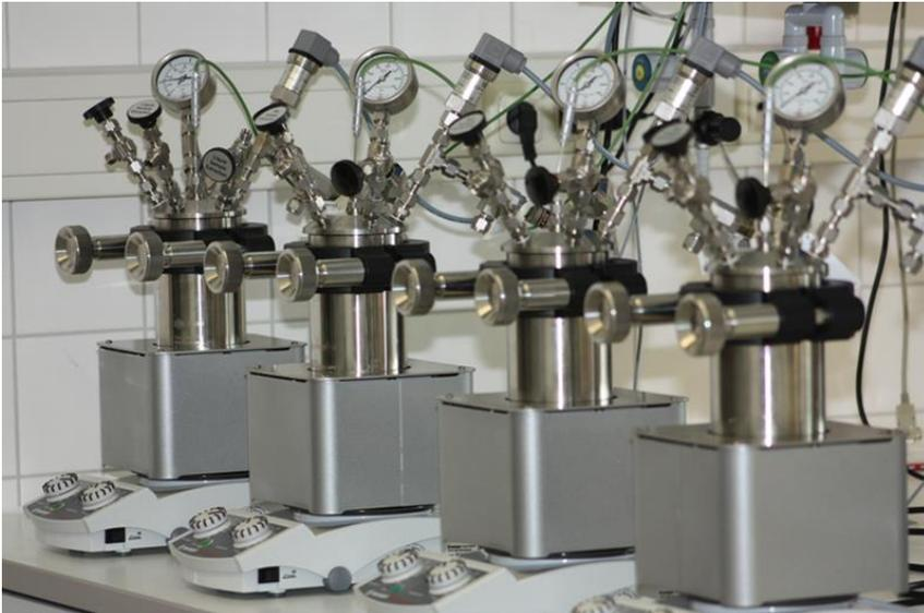
Abbildung 95: Hochdruckreaktoren BR-500
