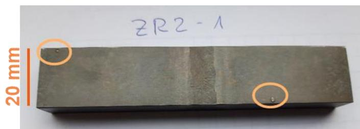
Abbildung 30: Blistering an Probe ZR2-1 (Rundschweißnaht)
